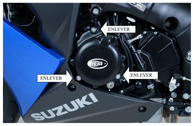
Le kit doit contenir : 1 x Protection carter moteur (ECC0201) 2x M6 x 1.00 x 50mm Boulons 1x M6 x 1.00 x 40mm Boulon
